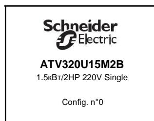
Экран отображения после первого включения графического терминала. Выберите язык и нажмите клавишу ENT.
