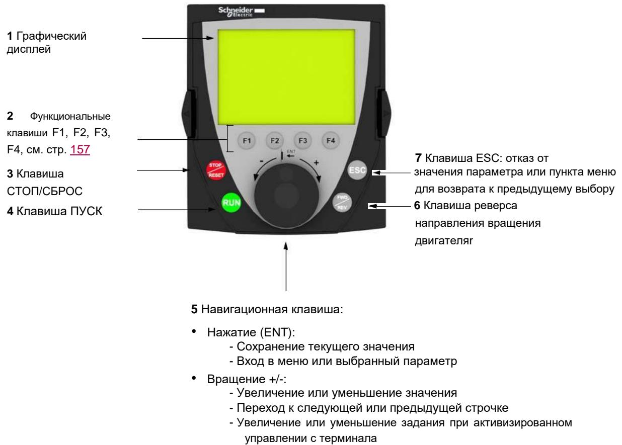
**Примечание:** Клавиши 3, 4, 5 и 6 обеспечивают непосредственное управление преобразователем при активированном управлении с терминала.
